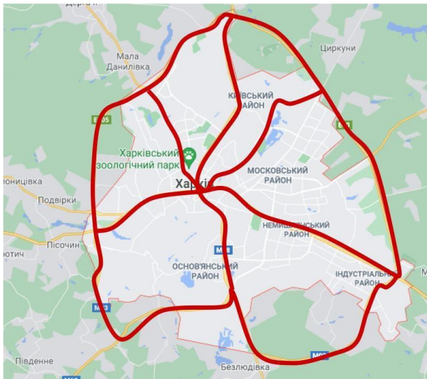
Рис. 4. Радіальна-кільцева система планування ВШМ на прикладі м. Харків
