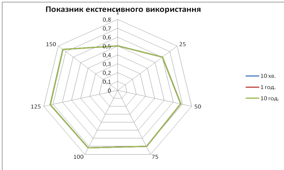
Рис. 3. Діаграма відношення екстенсивного використання обладнання в залежності від обсягу партії деталей, що виготовляється, при застосуванні циклу виготовлення партії деталей з використанням технології високошвидкісного різання на базі високопродуктивного інструменту
