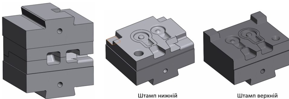
Рис. 8. 3D-модель молотового штампу для штампування поковки вушка гідроциліндру
