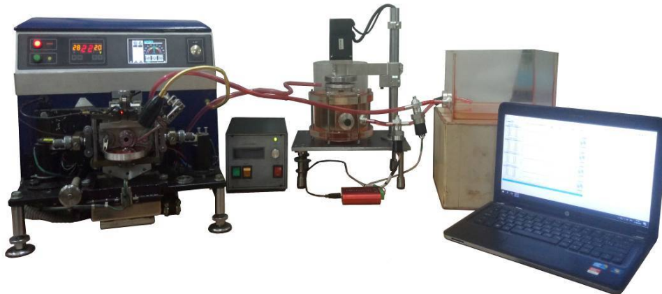
Рис. 4. Зовнішній вигляд комплексу лабораторних приладів для проведення триботехнічних випробувань двофазних масло-парогазових мастильних матеріалів з метою визначення їх оптимального поточного агрегатно-фазового стану
