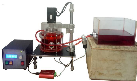
Рис. 3. Макет пристрою контролю поточного агрегатно-фазового стану робочої рідини у циркуляційних системах змащування
