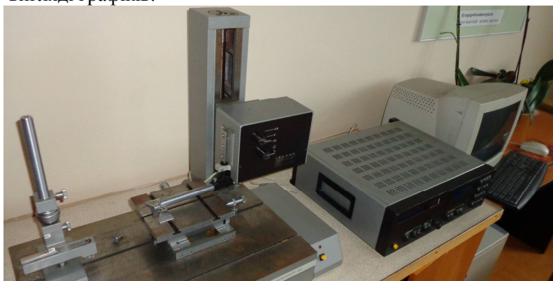
Рис. 5. Вимірювання шорсткості на приладі профілограф-профілометри мод. 201 заводу «Калібр».
