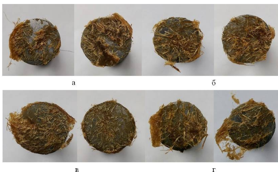
Рис. 3. Загальний вигляд поверхні клейового з'єднання біокомпозитів, наповнених дискретними волокнами технічної коноплі, із вмістом наповнювача: а – 20 мас. ч.; б – 25 мас. ч.; в – 30 мас. ч.; г – 35 мас. ч.
