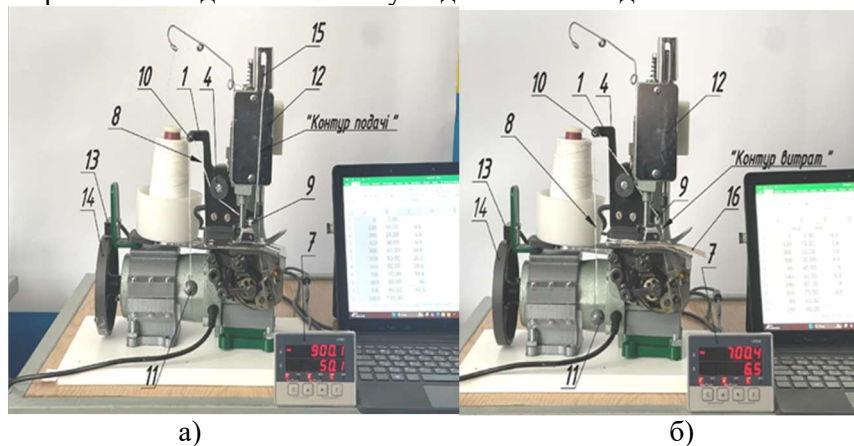
1 – швейна машина GK-9-2, 2 – індикатор, 3 – штатив, 4 – персональний комп'ютер (ноутбук), 5 – кнопка, 6 – магнітний маховик, 7 – датчик, 8 – цифровий дисплей для виміру кута повороту головного вала машини
