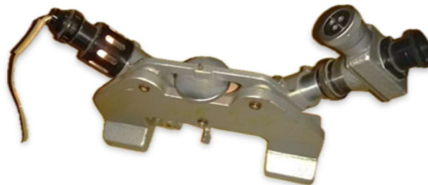
Рис. 4 Вимірювання шорсткості шпону за допомогою мікроскопа ТСП 4
