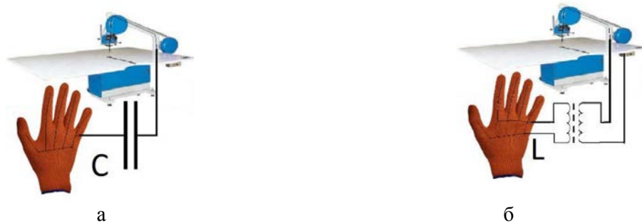
Рис. 4. Пропоновані схеми ємнісної (а), та індуктивної (б) реалізації зв'язку для захисної рукавички
