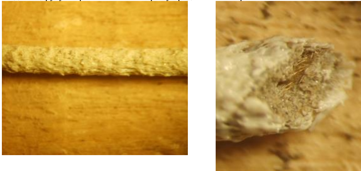
а б Рис. 2. Філамент після першого екструзування на echo extruder: а – загальний вид (x14), б – злам полімер-базальтового композиту (x28)
