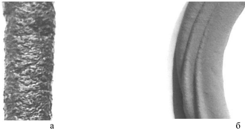
Рис.4. Стан поверхні зразків надрукованих з паст на основі \text{MoSi}_2 (а) та 40%TiC+40%TiB 2 +20%NiCr (б).
