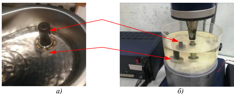
Рис. 2. Зовнішній вигляд резервуарів лабораторних пристроїв та способу позиціонування дослідних підшипників при проведенні їх очищення: а) УЗВ фірми «Kaisi»; б) приладу «Ultrasonic generator»; 1 – ложемент; 2 – дослідний авіаційний шарикопідшипник
