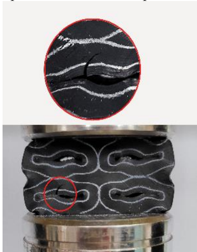
Рис. 9. Виявлена тріщина зразка другої групи з системою вільних отворів
