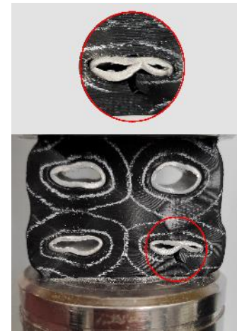
Рис. 11. Виявлена тріщина зразка третьої групи з системою підкріплених отворів
