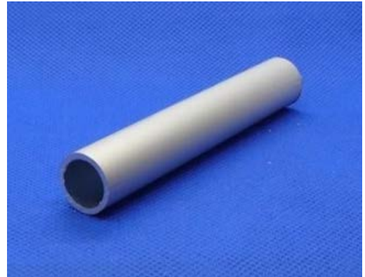
Рис. 2. Алюмінієва трубка для армування зразків
