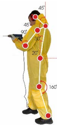
Рис. 1. Положення тіла працівника під час виконання отворів ручним інструментом у положенні стоячи
