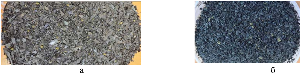
Рис.6. Подрібнені частки ABS пластику, що утворилися з відходів 3D-друку: а-частки після першого подрібнення; б-частки після другого подрібнення
