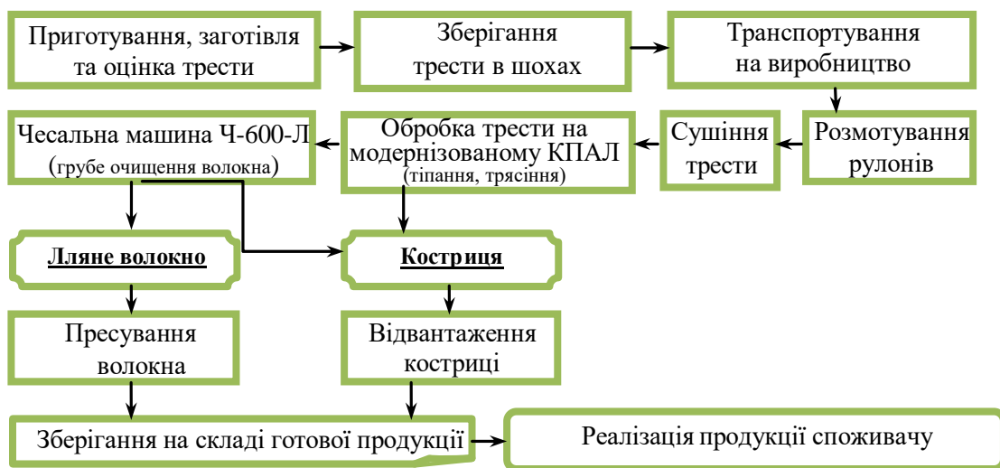
Рис. 5.10 – Технологічна схема первинної переробки трести льону олійного із застосуванням модернізованого КПАЛ (Україна)
