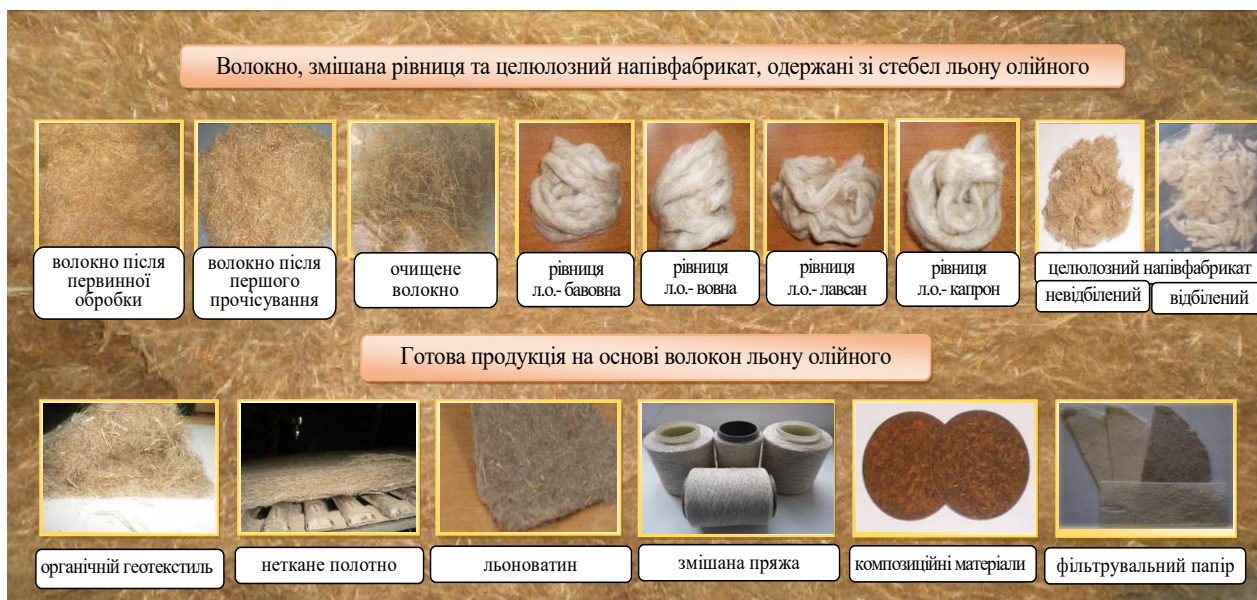
Рис. 1.9 – Зразки інноваційної продукції, виготовлені на основі волокон льону олійного у виробничих та лабораторних умовах
