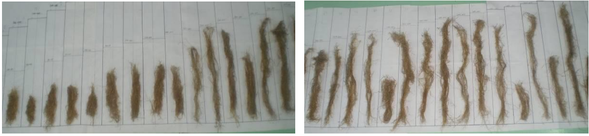
Рис. 3.7 – Ілюстраційне зображення виділеного волокна на діаграмі розподілу трести льону олійного за довжиною в кожній групі сорту Дебют
