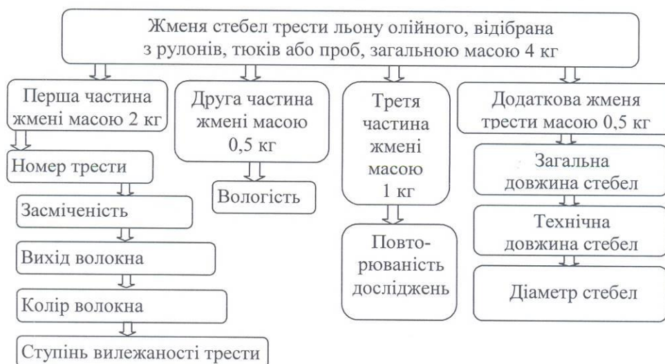
Рисунок 4 – Послідовність відбирання жмень стебел трести льону олійного та проведення випробувань
