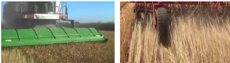
Рис. 3.1 – Збирання насіння льону олійного зернозбиральним комбайном із очісувальною жаткою «Слов'янка УАС-4»: а) збирання насіння; б) стеблостій після збирання насіння
