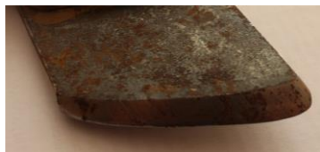
Рис. 2 – Формоутворення РЕ змінного долота лемеша (експлуатація на супіщаних ґрунтах)
