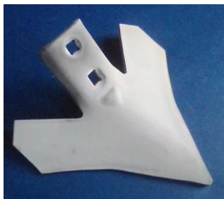
Рис. 6 – Зовнішній вигляд лапи культиватора, що модифікована азотуванням у тліючому розряді
