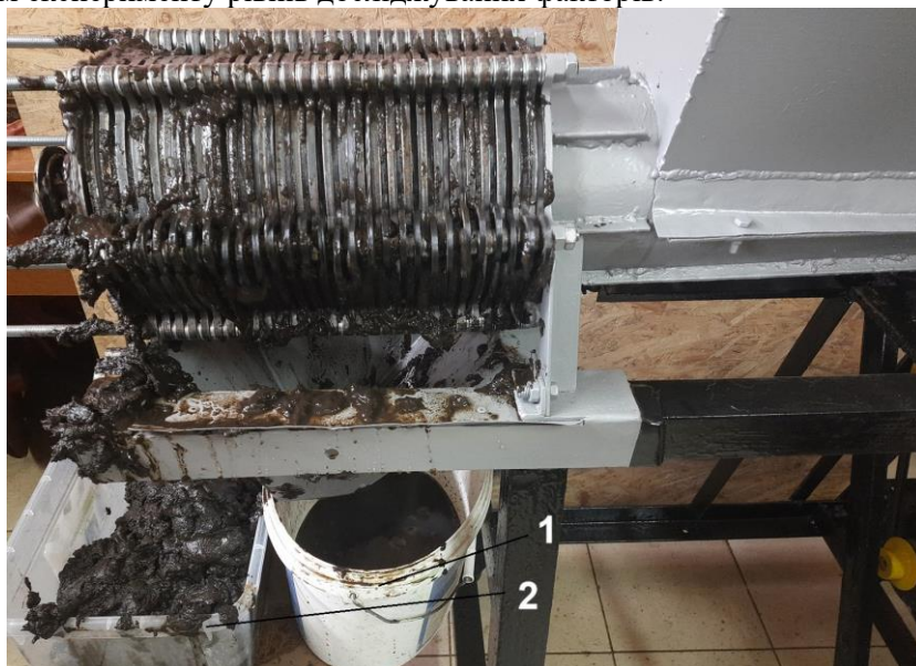
Рис. 3 – Фото процесу реалізації експерименту за таких значень досліджуваних факторів: n = 200 об/хв; \Delta = 0,4 мм; l = 0,3 м; F = 300 Н
