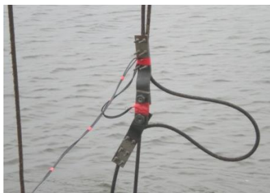
Рис. 4 – Схема закріплення динамометра на тяговому канаті
