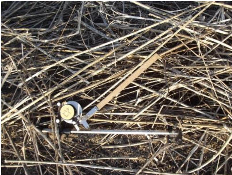
Рис. 2 – Дослідження кутової орієнтації стебел коноплі
