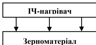
Рис. 1 - Схема термообробки зерна при ІЧ-енергопідводі
