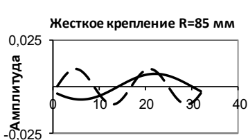
Рис 8 – Торцеве біення диска пили при жорстком ее закріпленні на радіусе измерения 85 мм
