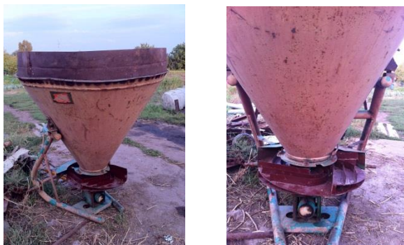
Рис. 5 – Навішування розробленого відцентрового робочого органа на машину МВУ-0,5
