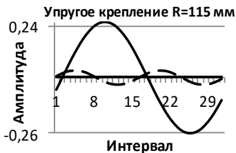
Рис 2 – Торцеве бієння диска пилы при упругом ее закрєплєннї на радїусє измерєннї 115 мм
