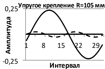
Рис 3 – Торцевє бієннє дїска пїлы прї упругом єє закрєплєннї на радїусє измерєннї 105 мм
