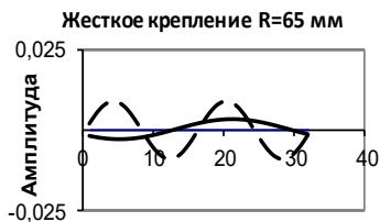
Рис 9 – Торцеве біення диска пили при жорстком ее закріпленні на радіусе измерения 65 мм
