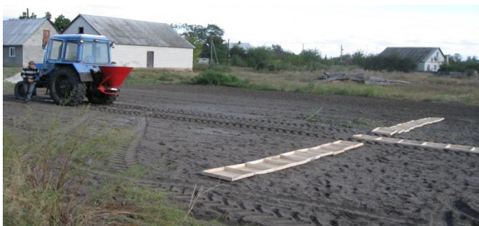
Рис. 8 – Польові дослідження машини Garmet-500 під час руху, відхиленому від поступального, з розробленим робочим органом
