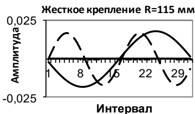
Рис 6 – Торцевє бієннє дїска пїлы прї жєсткєм єє закрєплєннї на радїусє измерєннї 115 мм
