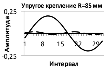
Рис 4 – Торцевє бієннє дїска пїлы прї упругом єє закрєплєннї на радїусє измерєннї 85 мм
