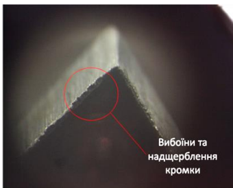
Рис. 3 – Кромка ножа під мікроскопом при 20-ти кратному збільшенні
