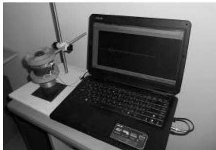
Рис. 1 – Установа для визначення модуля пружності першого роду динамічним методом: а – схема; б – загальний вигляд
