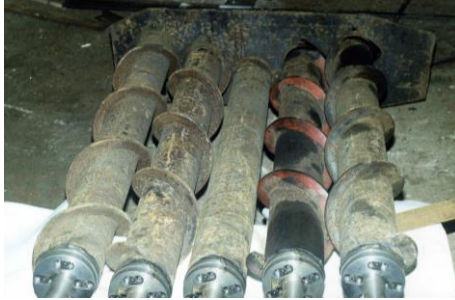
Рис. 2 – Гвинтовий циліндричний сепаратор зі зміщеними осями обертання
