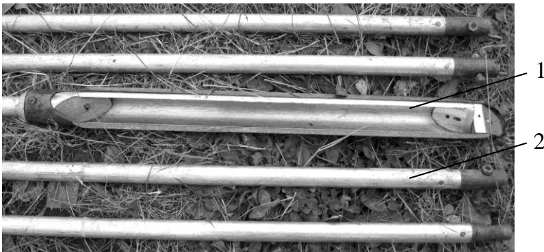
Рис. 1 – Фото сапропелерозвідувального бура: 1 – пробовідбірний човник; 2 – подовжувальні штанги
