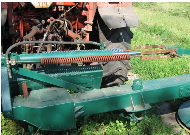
Рис. 2 – Модернізована система виважування різального блока косарки
