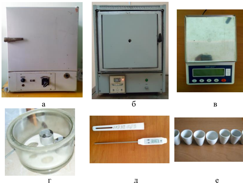
Рис 2 – Прилади та обладнання, що використовувалось під час досліджень: а – сушильна електрошафа СНОЛ – 3,5.3,5.3,5/3 ИЗ; б – муфельна електропіч СНОЛ – 1,6.2,5.1/11 ИЗ; в – електронні ваги ТЛВ-0,5; г – ексикатор із бюксами; д – термометр-щуп електронний TFA 301018; е – фарфорові бюкси
