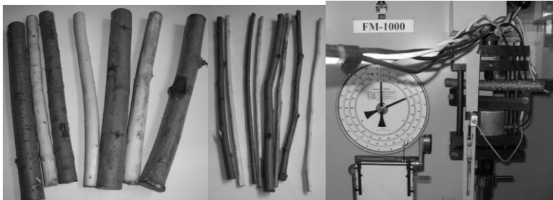
Рис. 1. Дослідні зразки і загальний вигляд машини FM-1000
