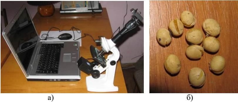
Рис. 4 – Визначення величини деформації поверхні насіння сої: а – загальний вигляд; б – деформоване насіння сої.
