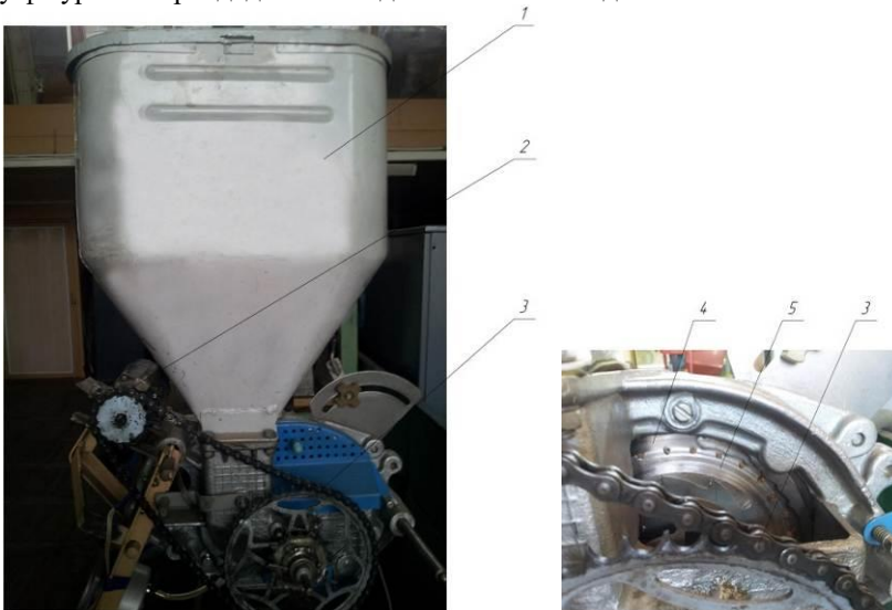
Рис. 5 – Експериментальна лабораторна установка; 1 – бункер; 2 – двигун; 3 – ланцюгова передача; 4 – висівний диск; 5 – додатковий диск
