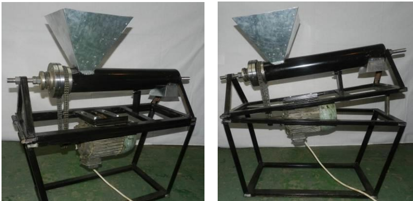
Рис. 4 – Загальний вигляд стенду для дослідження шнекового транспортера із запобіжним пристроєм
