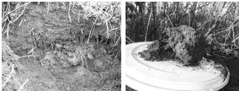
Рис. 1 – Проморожений сапропель: а) бургт в розрізі; б) затверділі включення нижнього шару
