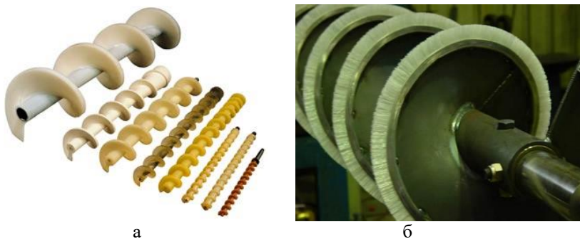
Рис. 2 – Гвинтові робочі органи італійської компанії «WAM Group» (а) з полімерним покриттям та шнек австралійської компанії «Bulknet» (б) з периферійною поверхнею виготовленою у вигляді еластичної щітки
