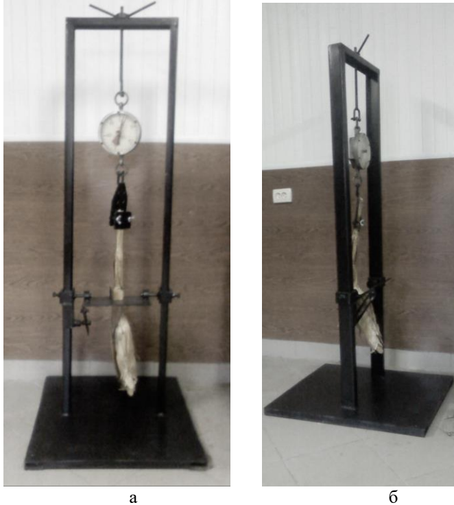
Рис. 2 - Прилад для визначення зусилля руйнування плодоніжки качана кукурудзи: а – вид спереду; б – вид збоку
