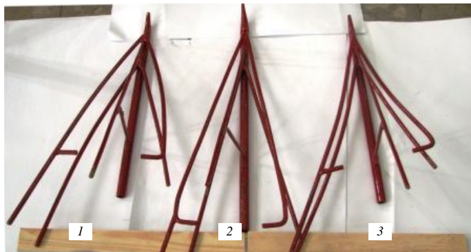
Рис. 2 – Подільники з формою бічного прутка: 1 – опуклою; 2 – прямолінійною; 3 – вгнутою
