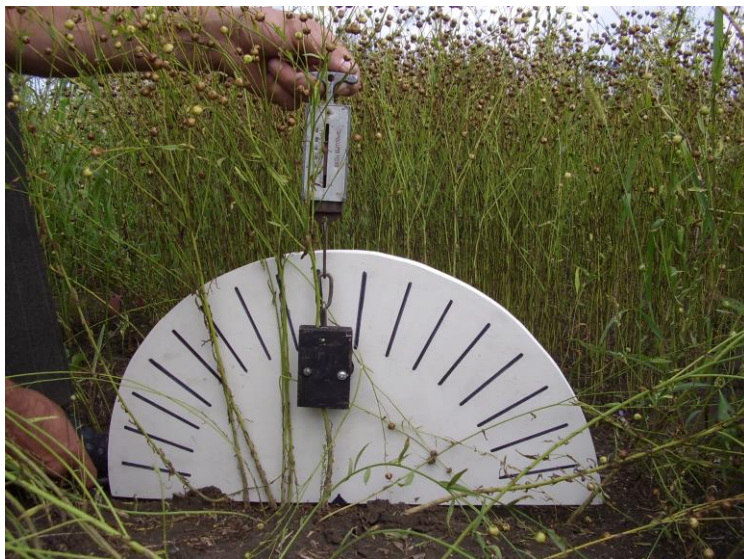
Рис. 2 – Визначення сили брання стебла льону олійного
