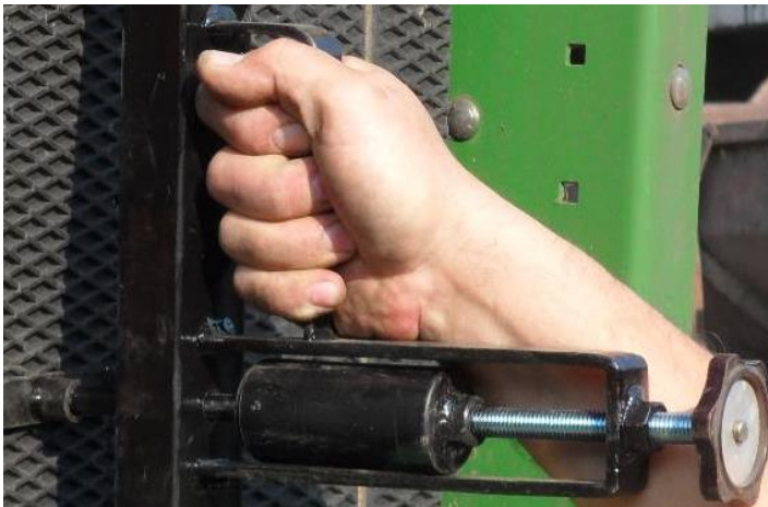
Рис. 2 - Визначення прогину нескінченних пасів рулонного прес-підбирача
