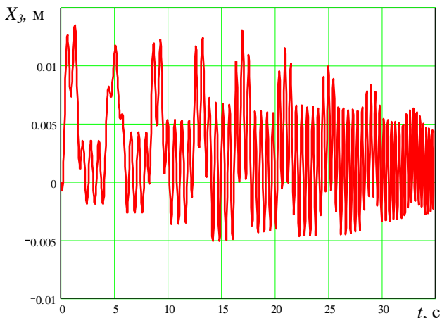
Рис. 6. Графік переміщення корпусів приводного барабана ланцюгово–пластинчастого транспортера під лінією навантаження P , Н
