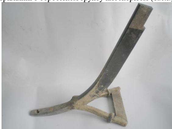
Рис.1. Розроблений робочий орган для глибокого розпушування ґрунту в міжряддях цукрових буряків
