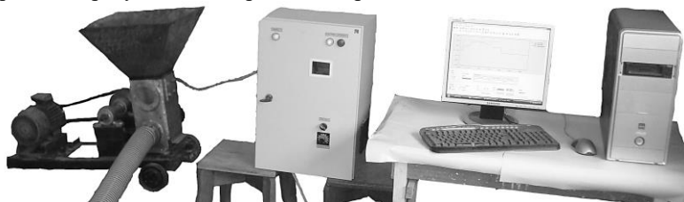
Рис.2. Загальний вигляд експериментальної установки та обладнання для регулювання частоти обертання ротора електродвигуна і отримання результатів
