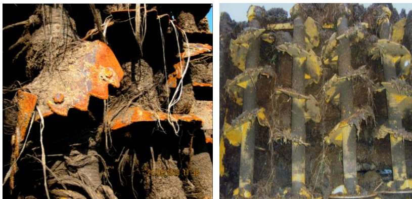
Рис.1. Деформації бітерів в технологічному процесі з напівперепрілим гноєм
