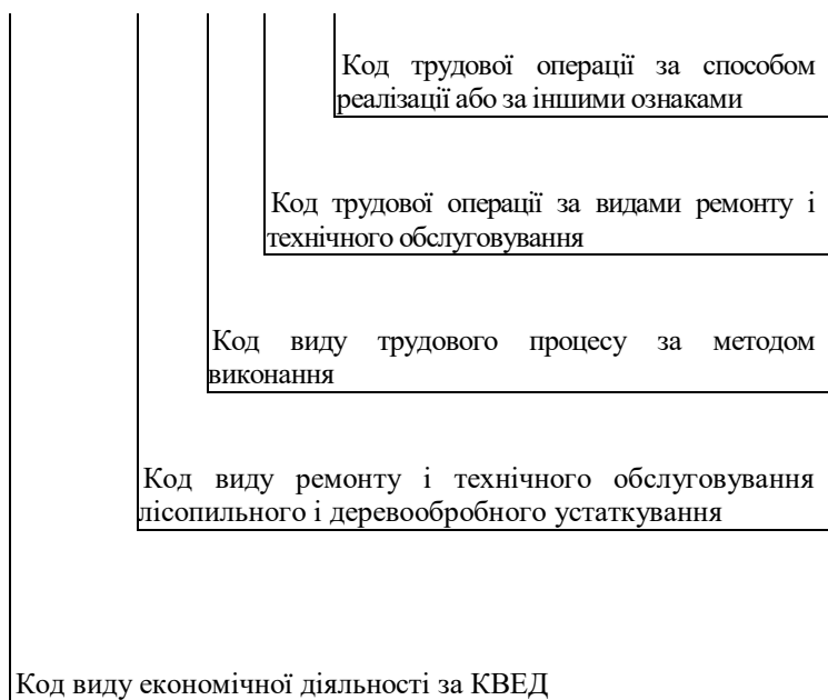
Рис. Загальне кодове позначення процесів ремонту і технічного обслуговування лісопилного та деревообробного устаткування
