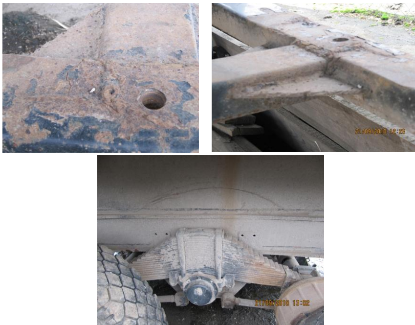
Рис. 1. Вихід з ладу металоконструкцій мобільних сільськогосподарських машин
