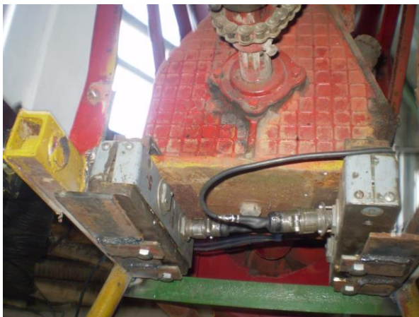
Рис.2. Встановлення вимірювальних засобів для проведення експериментальних досліджень навантаженості
