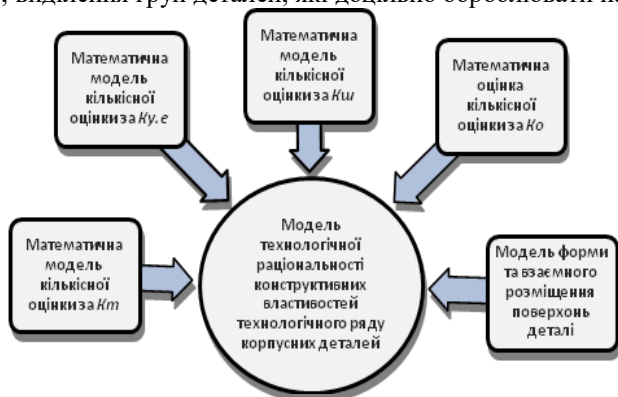
Рис.1. Схема підбору деталей для обробки на металорізальних верстатах
