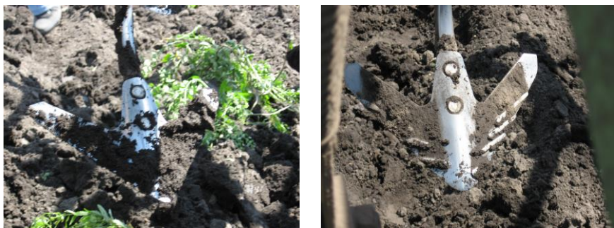
Рис. 2. Залипання ґрунтом дослідних зразків лап
