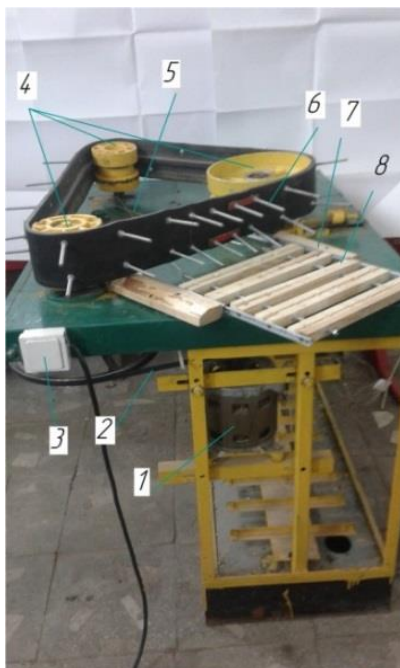
Рис. 1 – Експериментальна установка для дослідження збирання стебел конопель
