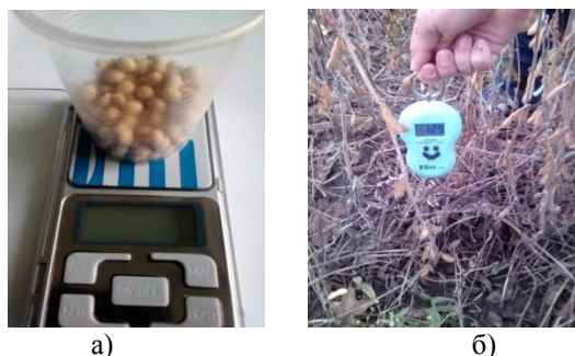
Рис. 4 – Дослідження зусиль терелення стебла сої з ґрунту та визначення масових показників насіння
