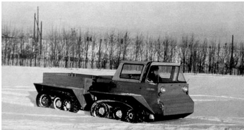
Рис. 2 – Дослідна машина з пневматичними однопорожнистими гусеницями
