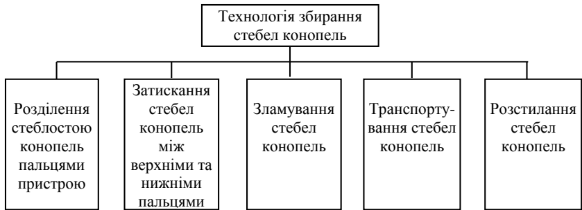
Рис. 2 – Функціональна схема технологічного процесу збирання стебел конопель
