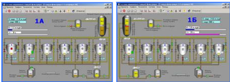
Рис. 1 – Система керування процесами фільтрування на Гнідавському цукровому заводі
