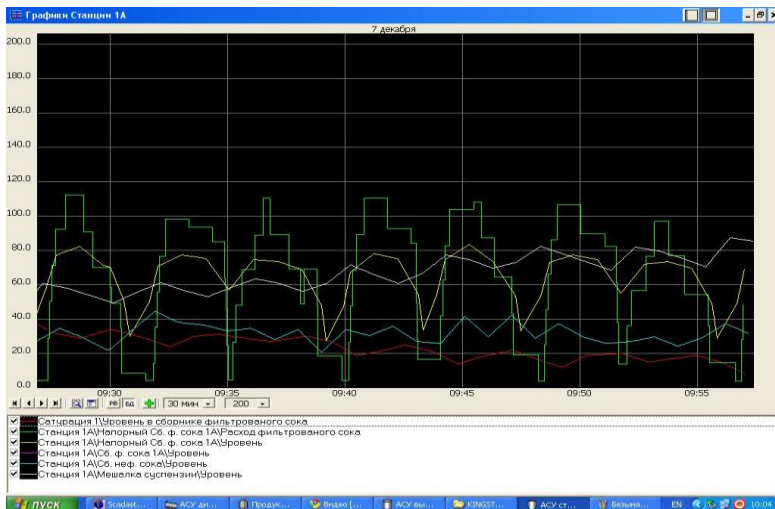
Рис. 2 – Графіки залежності для основних параметрів процесу фільтрування дифузійного соку (рівнів у збірниках соку, витрати фільтрованого соку)
