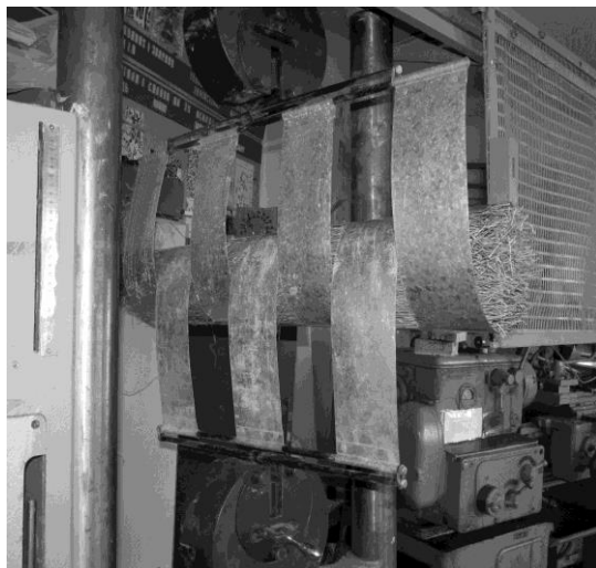
Рис. 2 – Стиснення снопа стеблової стрічки льонотрести у пристосуванні на універсальній розривній машині УММ-5
