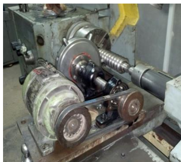
Рис. 1 – Конструктивна схема інструмент для зміцнення гвинтових робочих органів а) та експериментальна установка для проведення досліджень б)
