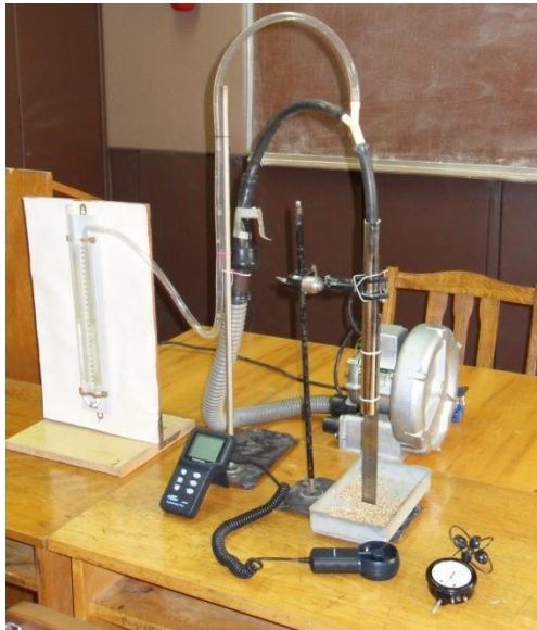
Рис.1 – Загальний вигляд лабораторної установки для визначення максимально допустимої висоти установки дифузора над хлібостоєм
