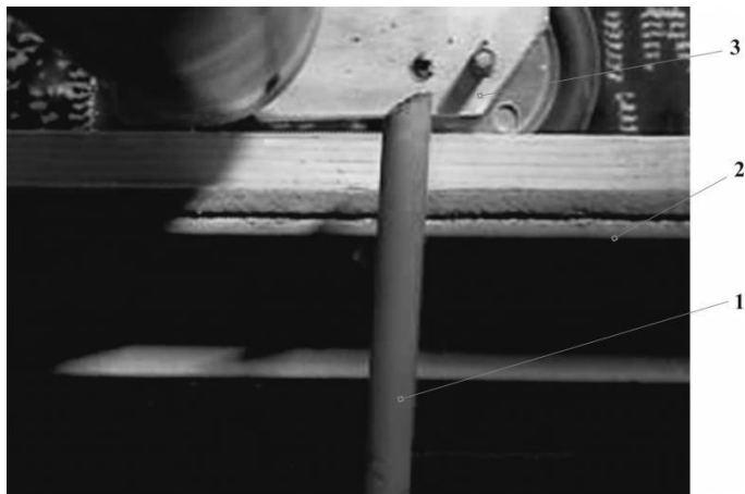
Рис. 2 – Фото початкової стадії експерименту: 1 – фізична модель стебла; 2 – рама дослідної установки; 3 – візок з робочим органом
