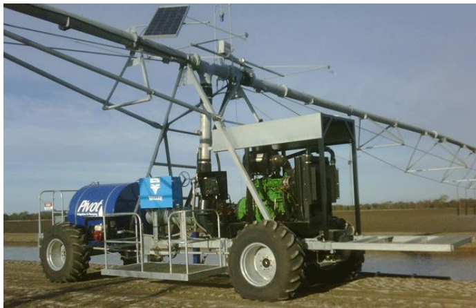
Рис. 3 – Дощувальна машина Valley Rainger
