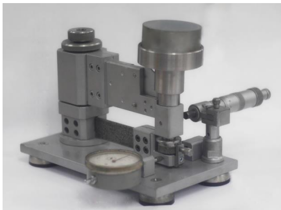
Рис. 2 – Пристрій для дослідження коефіцієнта тертя (а – принципова схема; б – загальний вигляд):
