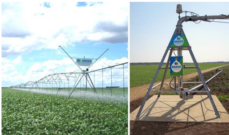
Рис. 2 – Дощувальна машина Centerstar 9000
