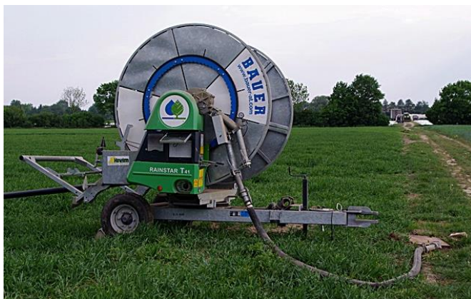
Рис. 4 – Машина дощувальна шлангово-барабанна
