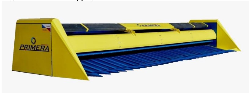
Рис.6 – Соняшникова жатка Primera Бердянського заводу сільгосптехніки
