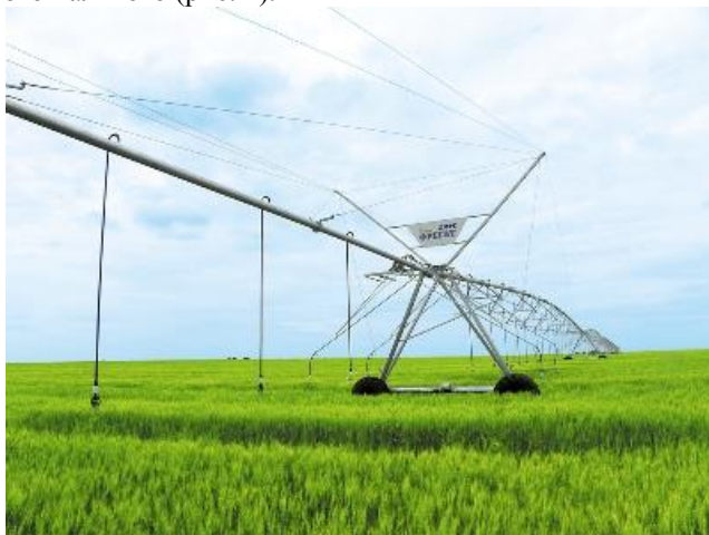
Рис. 1 – Дощувальна машина «Фрегат» з електричним приводом
