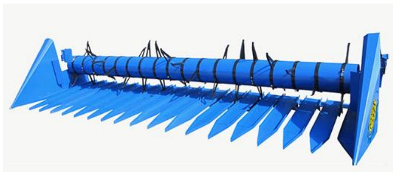
Рис.7 – Полегшена соняшникова жатка Бердянського заводу сільгосптехніки
