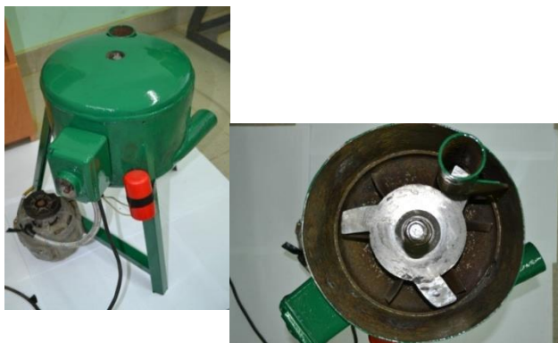
Рис.3 – Загальний вигляд установки для подрібнення льону олійного(а) та розміщення подрібнюючого пристрою у корпусі (б)
