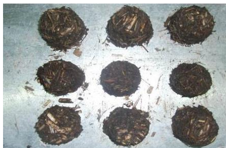
Рис.1 – Дослідження формування паливних матеріалів з додаванням в'язучої речовини – озерного сапропелю вологістю 83%
