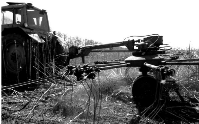
Рис. 1 – Збирання стебел коноплі роторними граблями
