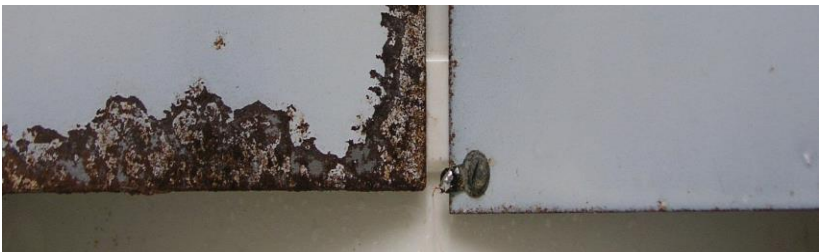
Рис. 5 – Зразки металевих пластин після 6-и місяців знаходження в соляному середовищі; a – контрольна пластина; б – пластина, підключена до пристрою захисту від корозії
