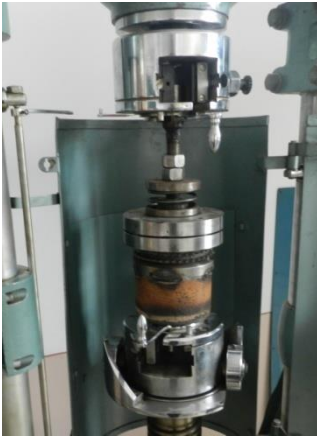
Рис. 5 – Загальний вигляд стенду, на якому встановлена запобіжна муфта
