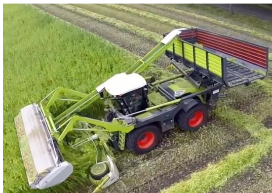
Рис. 13 – Збирання коноплі кукуруддозбиральним комбайном з попереднім відчісуванням [10]
