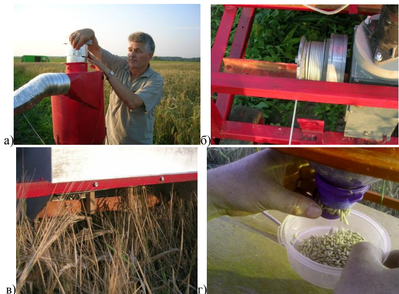
Рис.3 – Фрагменти експериментальних досліджень пневмовловлювача: а) регулювання глибини розрідження в циклоні; б) змотування каната на барабан лебідки; в) підведення планками мотвила стебел в середину пневмовловлювача; г) пересипання зерна з циклона в лоток
