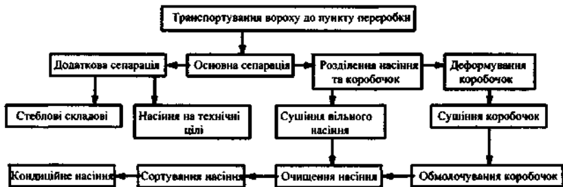
Рис. 2. Послідовність операцій під час переробки льняного вороху
