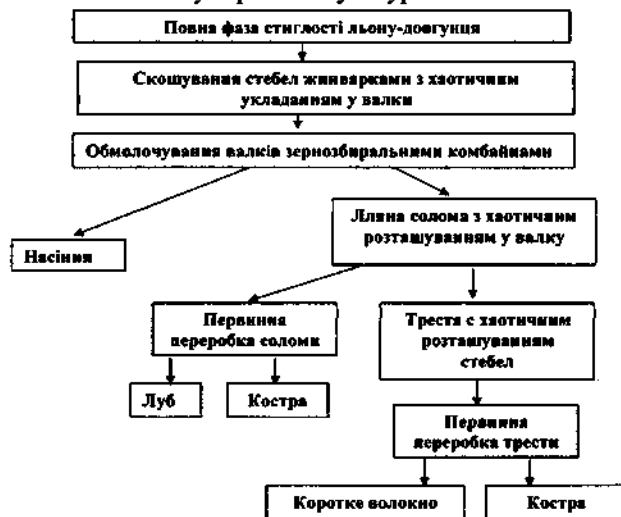
Рис. 2. Технологія збирання льону за нетрадиційною технологією
