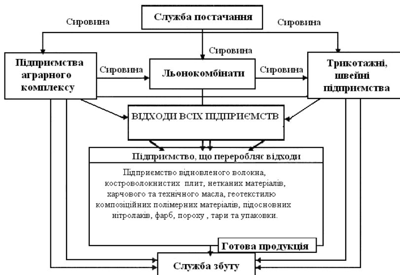
Рис. Схема використання льону в безвідходному виробництві
