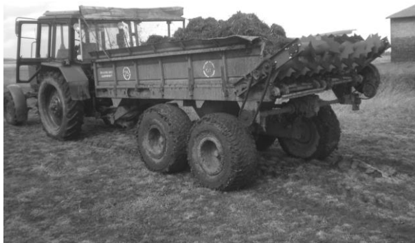
Рис. 2. Експериментальний зразок розкидача органічних добрив
