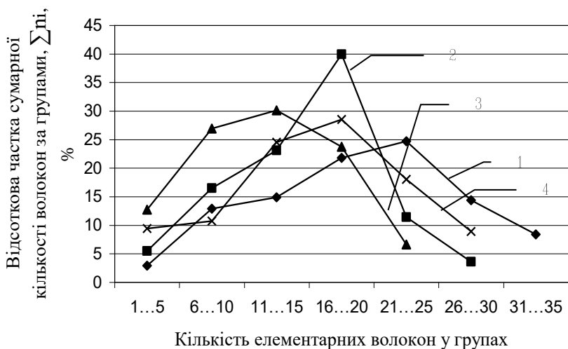
Рис. 3. Криві розподілу, що характеризують тіпане лляне волокно: 1 – льон тіпаний (контрольний зразок); 2 – льон тіпаний, отриманий після обробки соломи композицією з натрієвою сіллю додецилбензолсульфокислоти – 0,7 г/л; 3 – льон тіпаний, отриманий після обробки соломи композицією з оксіетильованим нонілфенолом АФ 9-10 – 0,7 г/л; 4 – льон тіпаний, отриманий після обробки соломи композицією з натрієвою сіллю додецилдіоксіетилсульфокислоти – 0,7 г/л.
