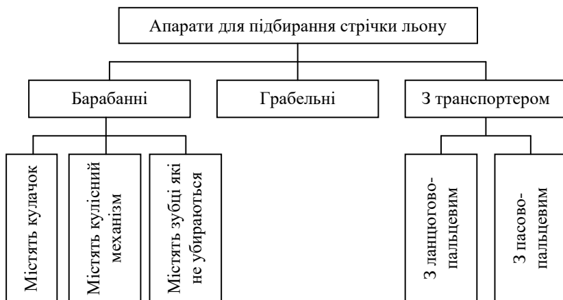
Рис. 1. Класифікація підбираючих апаратів
