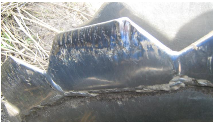
Рис. 3. Електроерозійне покриття робочої поверхні важких дискових борін
