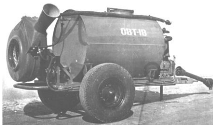
Рис. 2. Обприскувач вентиляторний тракторний
