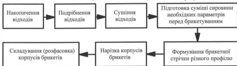
Рис. 2. Технологія виготовлення брикетів з рослинної сировини
