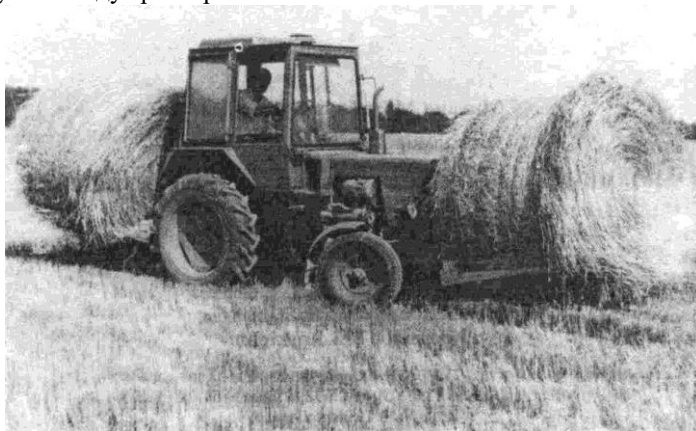
Рис. 1. Підбирач-збирач рулонів льону, сіна і соломи (ПСР-2)
