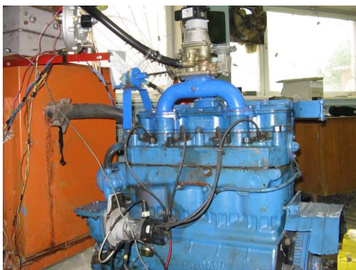
Рис. 1. Газовий двигун, переобладнаний з дизеля Д-240
