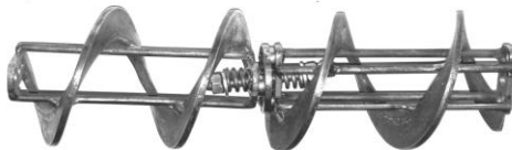
Рис.8. Загальний вигляд зразка секцій гвинтового робочого органу
