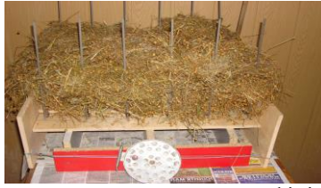
Рис.1. Схема лабораторної установки для визначення коефіцієнта сепарації вороху льону при розтягуванні шару матеріалу та її загальний вигляд
