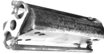
Рис.6. Демонтування каркаса секції від основи
