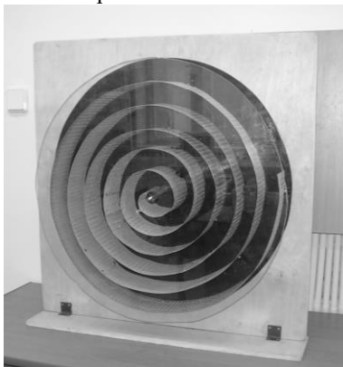
Рис. 2. Лабораторна установка для дослідження параметрів спіралі барабанної сушарки
