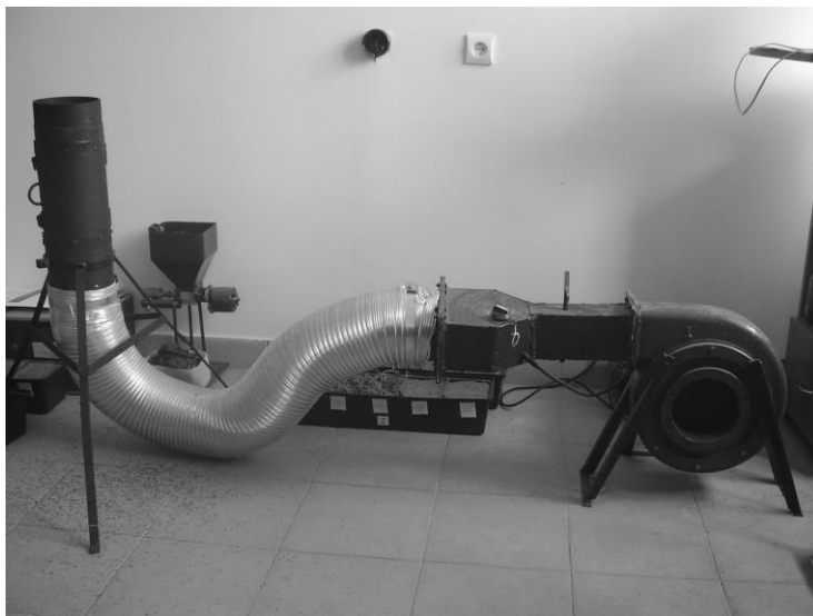
Рис. 1. Лабораторна установка для дослідження процесу конвективного сушіння вороху насіння трав
