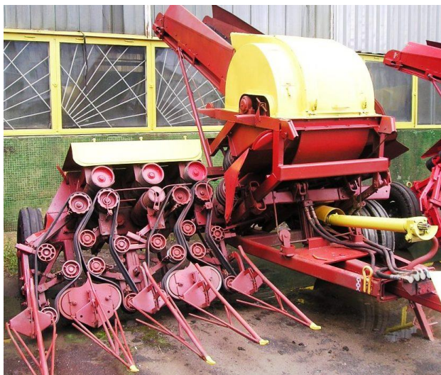
Рис. 3. Льнокомбайн з боковим розташуванням брального апарату
