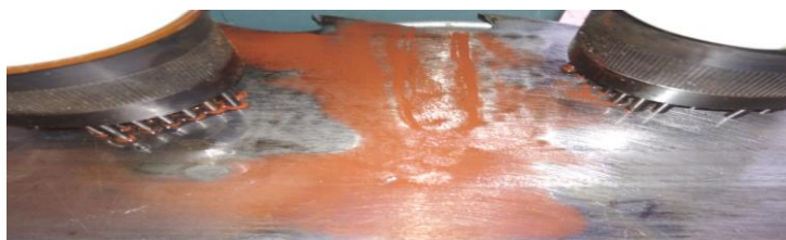
Рис. 3 - Намагнічування ділительних пилок способом прикладеного поля: індикаторні рисунки зразків, відповідно - №4 (а); №5 (б); №6 (в); №7 (г)
