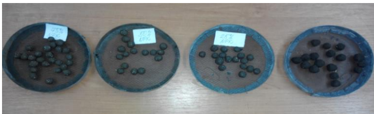
Рис. 4 - Зразки отриманих гранул з органо-мінеральної суміші для використання при подальших дослідженнях: а) – органічна речовина (75%)+NPK (25%); б) - органічна речовина (50%)+NPK (50%); в) - органічна речовина (25%)+NPK (75%); г) – органічна речовина
