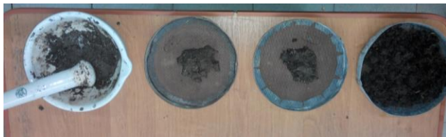
Рис. 1 – Зразки отриманої органо-мінеральної суміші для використання у подальших дослідженнях: а) – органічна речовина (75%)+NPK (25%–); б) - органічна речовина (50%)+NPK (50%); в) - органічна речовина (25%)+NPK (75%); г) – органічна речовина.
