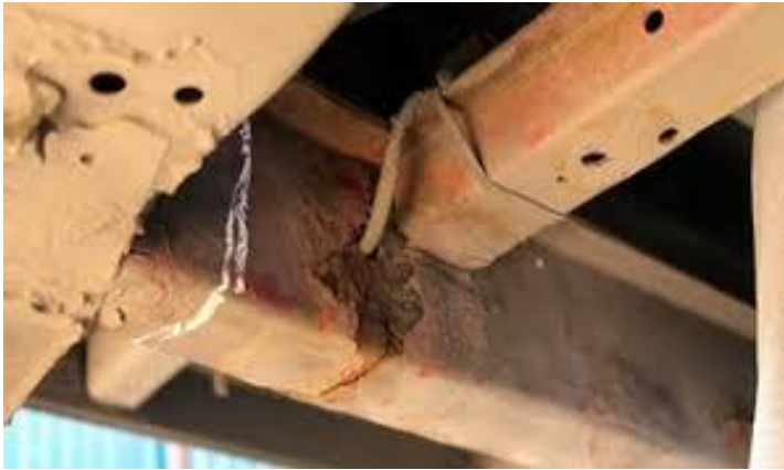
Рис. 1 – Поява тріщини у балці лонжерона автомобіля
