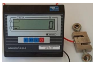
Рис. 2 – Схема будови електронного динамометра та загальний вигляд його екрану при відображенні значення сили:
