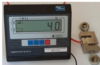
Рис. 2 – Схема будови електронного динамометра та загальний вигляд його екрану при відображенні значення сили:
