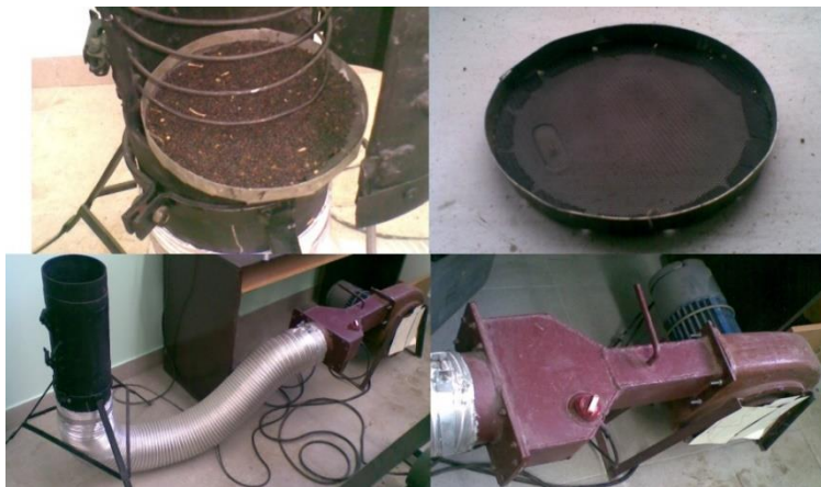
Рис. 1 – Установа для дослідження процесу сушіння насіння ріпаку
