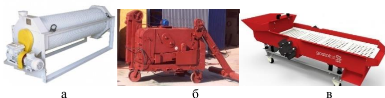
Рис. 1 – Конструкції сепараторів: а – трієр БТХМ; б – решето-трієрна машина СМ-4; в – вібраційний сепаратор Gostol TST
