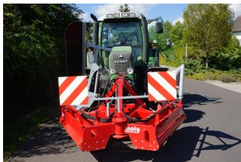
Рис. 2 – Валкоутворювач гарбузів МΟΥ
