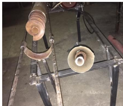
Рис. 3 - Стенд для дослідження телескопічних гвинтових транспортерів в розібраному стані
