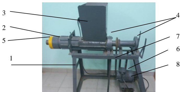
Рис. 2 – Дослідна установка шнекового дозатора
