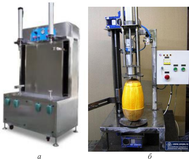
Рис. 5 – Машина для очищення гарбуза (Росія): а - Titan FXR-99 (Довгопрудний, Росія); б – машина виробництва ООО «Воплощение» (Подільськ, Росія)
