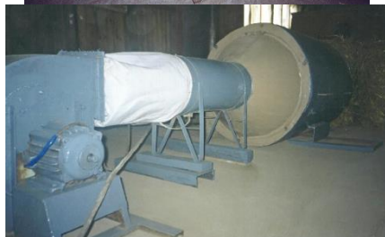
Рис.6 – Схеми сушіння рулонів із диференційованим підводом сушильного агента (а), (б) та загальний вигляд сушарки (в)
