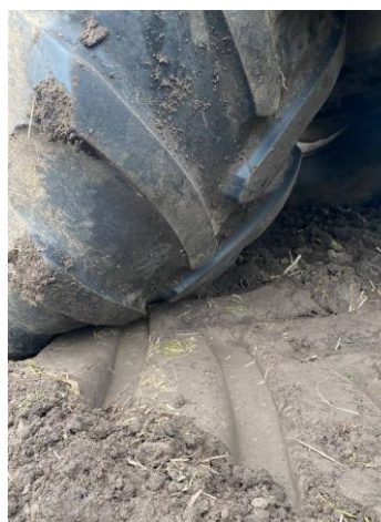
Рис. 1 – Ущільнення ґрунту після проходження сільськогосподарської техніки
