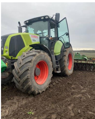
Рис. 1 – Ущільнення ґрунту після проходження сільськогосподарської техніки
