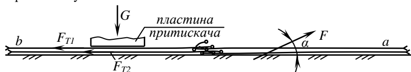
Рис. 2. Схема сил, що діють на стебла під час виконання обертання стрічки обертачем, обладнаним притискаючим пристроєм
