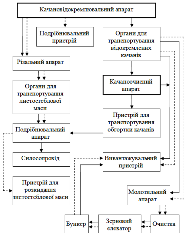
Рис. 2. Функціональна схема різних варіантів компоновки кукурудозбиральної машини: → вітчизняна технологічна схема; - → західна технологічна схема
