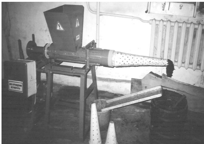
Рис.1. Загальний вигляд прес-шнека: 1 – рама; 2 – електродвигун; 3 – редуктор; 4 – бункер живильний; 5 – шнек; 6 – спрямовувач; 7 – корпус; 8 – змінна конусна насадка
