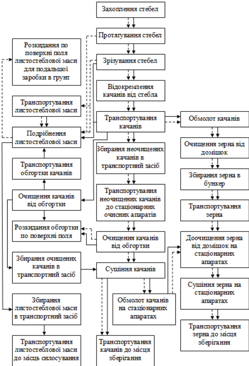
Рис. 1. Функціональна схема існуючих моделей технологічного процесу збирання кукурудзи на зерно: → вітчизняна технологічна схема; - -> західна технологічна схема
