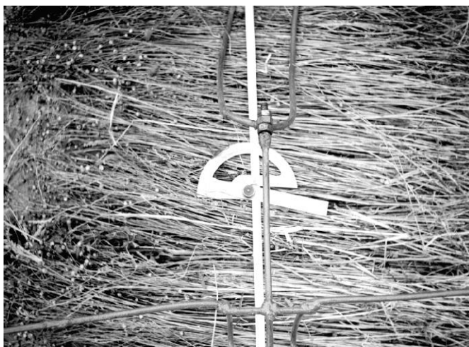
Рис. 2. Визначення переплутаності в стрічці льону
