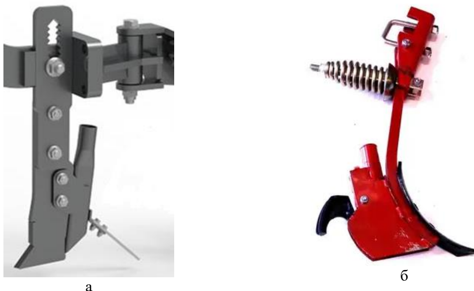
Рис. 2. – Загальний вигляд сошників із гострим кутом входження в ґрунт: а – анкерний; б – лаповий
