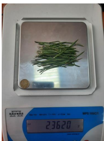
Рис. 2 – Визначення маси хвої на лабораторній вазі WPS 110/C/1 (Польща)
