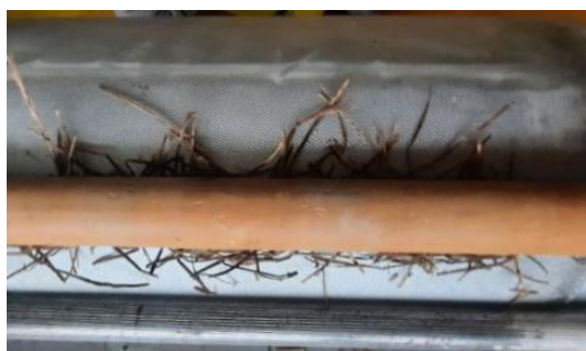
Рис. 4 – Оброблення хвої та волокна шляхом пропускання між рифленими (а) та прогумованими (б) валами
