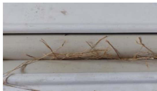
Рис. 4 – Оброблення хвої та волокна шляхом пропускання між рифленими (а) та прогумованими (б) валами
