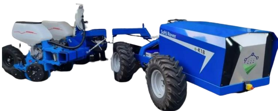
Рис. 8 – Багатофункціональний сільськогосподарський робот SoftiRover e-K18
