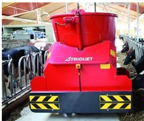
Рис. 2 – Самохідний робот для змішування та дозування кормів TRIOMATIC
