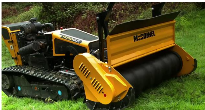
Рис. 6 – Телекерований трактор Robocut (McConnel, Англія)
