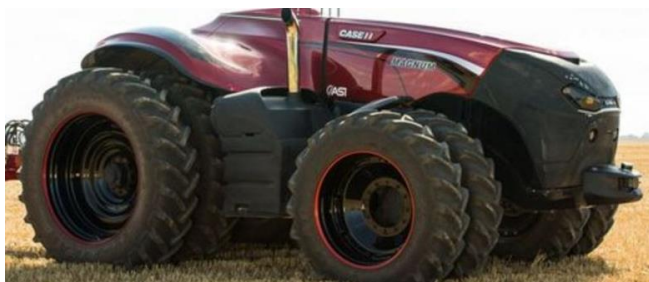
Рис. 4 – Робототрактор Case IH Magnum (CNH Industrial NV, Нідерланди)
